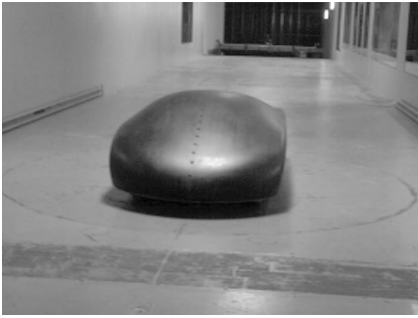
图 4 形体在风洞中的安装 Fig. 4 Aerodynamic optimization shape fixed in wind tunnel
